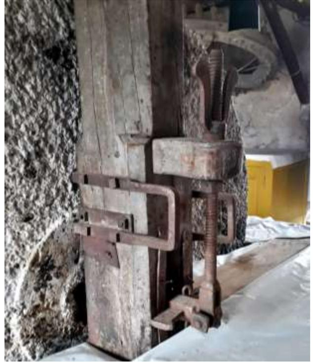
Crochets en fer et vis de réglage
